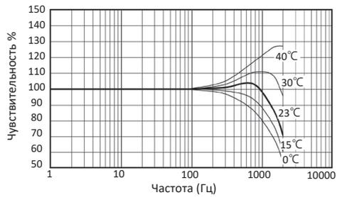
Датчики ускорения могут иметь различные частотные характеристики, отличаться отношением выходной чувствительности к частоте в зависимости от температуры.
